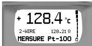
Messung von 128,4°C von einem Pt100 mit 2-Leiter-Anschluss und Trendgrafik AUS.
